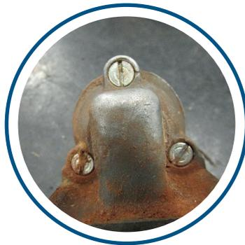
Motor de partida com os três parafusos de fixação da chave magnética substituídos por outros não utilizados pela SEG.
