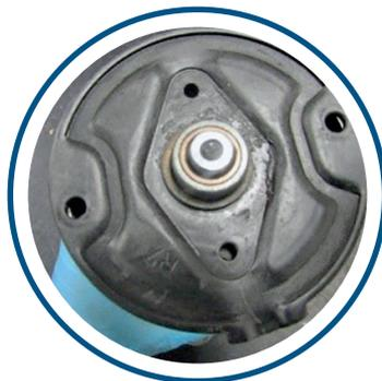
O motor não apresenta os tirantes de fixação, parafusos de fixação da tampa e as arruelas de contato e trava.
